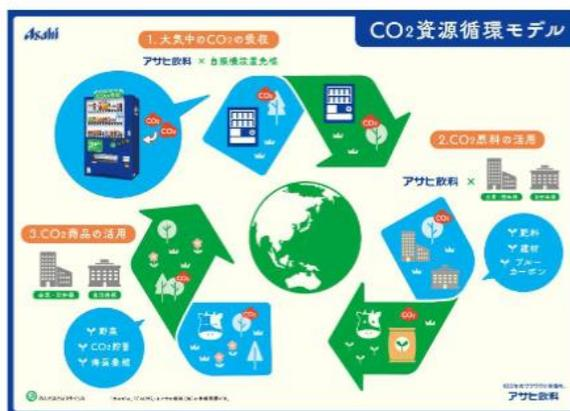
庫内にCO<sub>2</sub>を吸収する特殊材を搭載した自動販売機は、周辺の大気を吸いこみ、それを利用して商品を冷やしたり温めたりしています。庫内に搭載した特殊材が大気中のCO<sub>2</sub>のみを吸収する仕組みで、CO<sub>2</sub>を吸収しても自動販売機の稼働に影響はなく、大気中のCO<sub>2</sub>を吸収する木と同じような役割を果たし、脱炭素社会の実現に貢献します。
